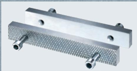
Las mordazas intercambiables se pueden utilizar por ambas caras. Tienen una cara grafilada y otra lisa. Se sujetan por dos tornillos con cabeza exagonal hembra.
